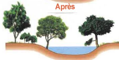
— **élagage ou recépage ponctuel** sans dessoucher afin de ne pas déstabiliser les berges. Cette opération doit être réalisée de façon à conserver une alternance de zones d'ombre et de lumière. Les déchets, débris de coupes, rémanents de broyage sont évacués afin de ne pas créer d'embâcles<sup>(1)</sup> supplémentaires.
